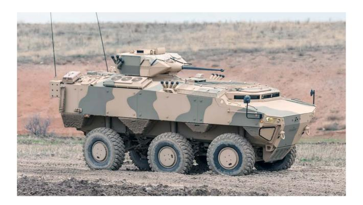
Avec une autonomie de plus de 800 km, le PARS III 6x6 est équipé de réservoirs de carburant de sécurité contre les crevaisons et les explosions, un réservoir de carburant de réserve sous blindage étant également disponible en cas d'urgence.
