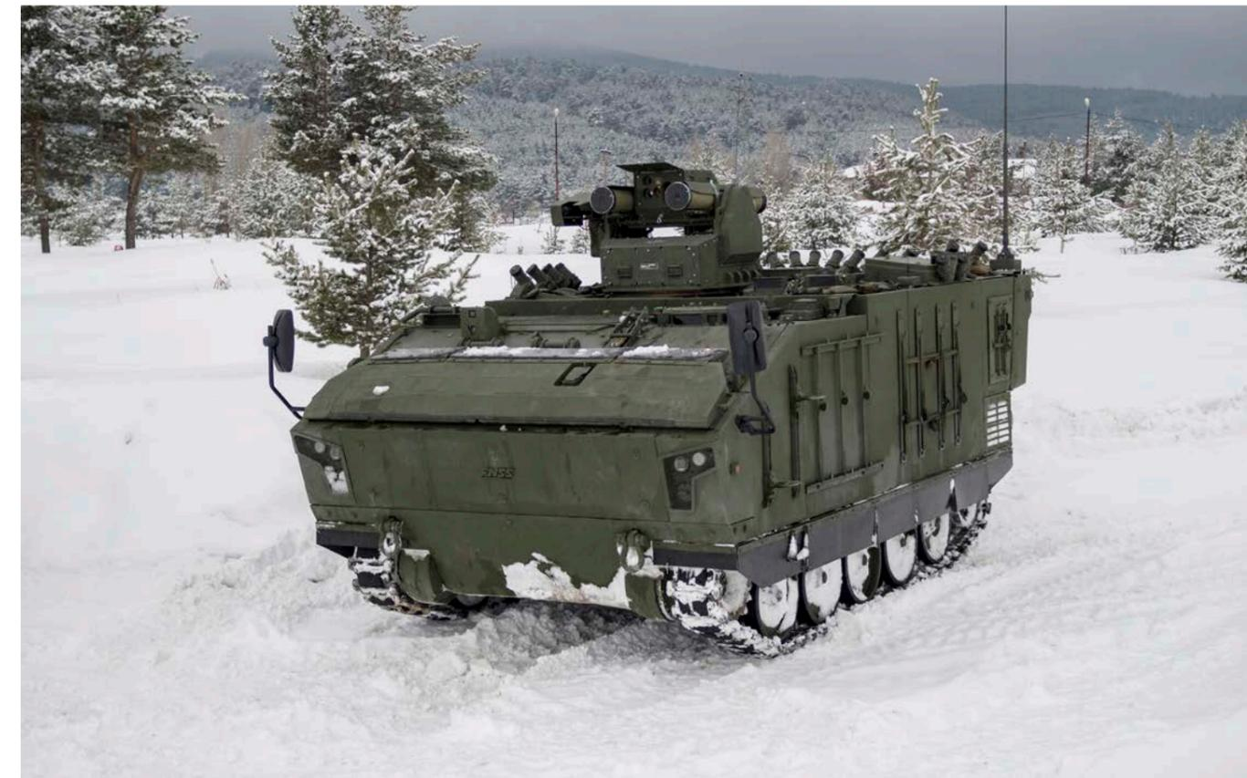
La coque du KAPLAN-10 est fabriquée et intégrée selon une technique de soudage balistique. Le groupe motopropulseur et le pilote sont situés à l'avant du véhicule tandis que le chef d'engin et le tireur, se trouvent au centre. La partie arrière est occupée par l'aide-tireur, des places étant disponibles pour du personnel supplémentaire.
