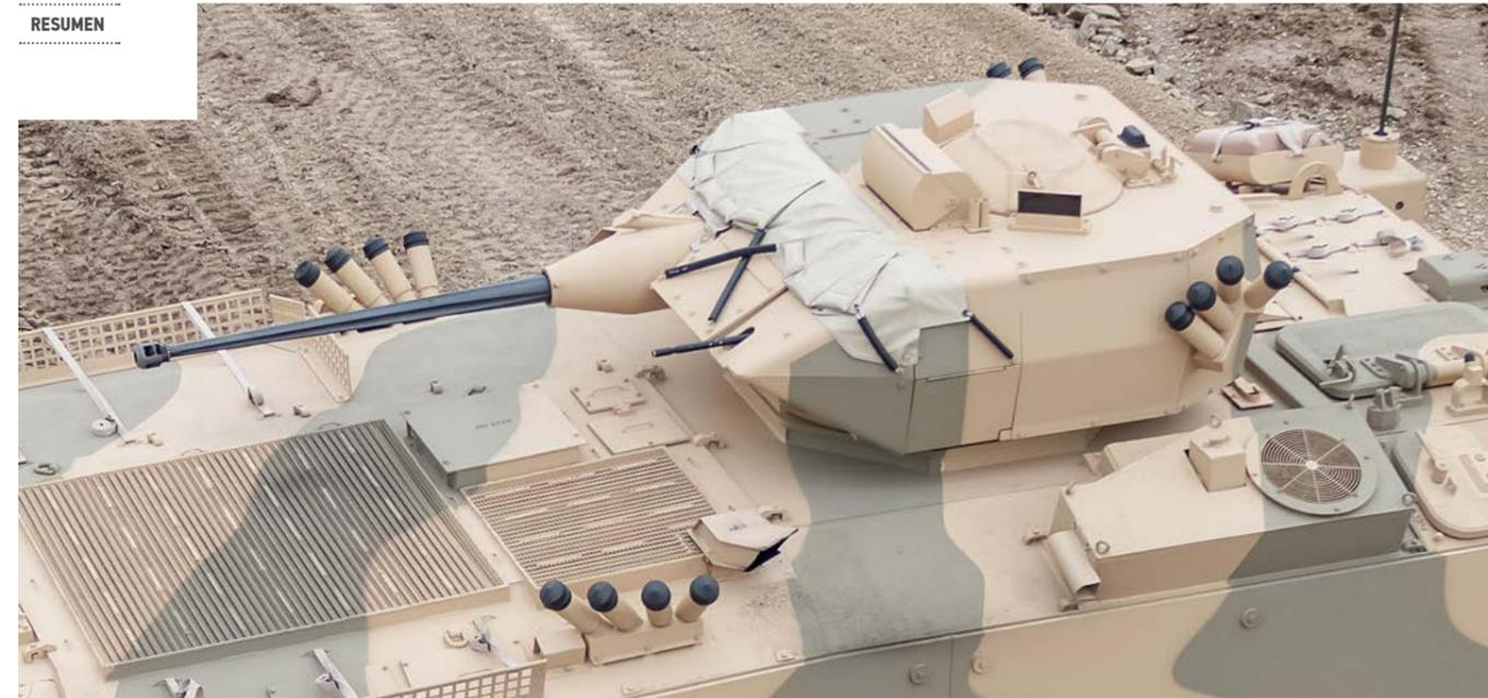
**La SABER es una torre monoplaza de calibre mediano, accionada eléctricamente, que puede integrarse en vehículos blindados sobre ruedas y cadenas. La torre SABER está equipada con las últimas tecnologías en accionamiento de torre, dirección de tiro, protección y letalidad. Sus dimensiones compactas y su reducido peso hacen de la SABER una opción adecuada para diferentes tipos de vehículos blindados.**
