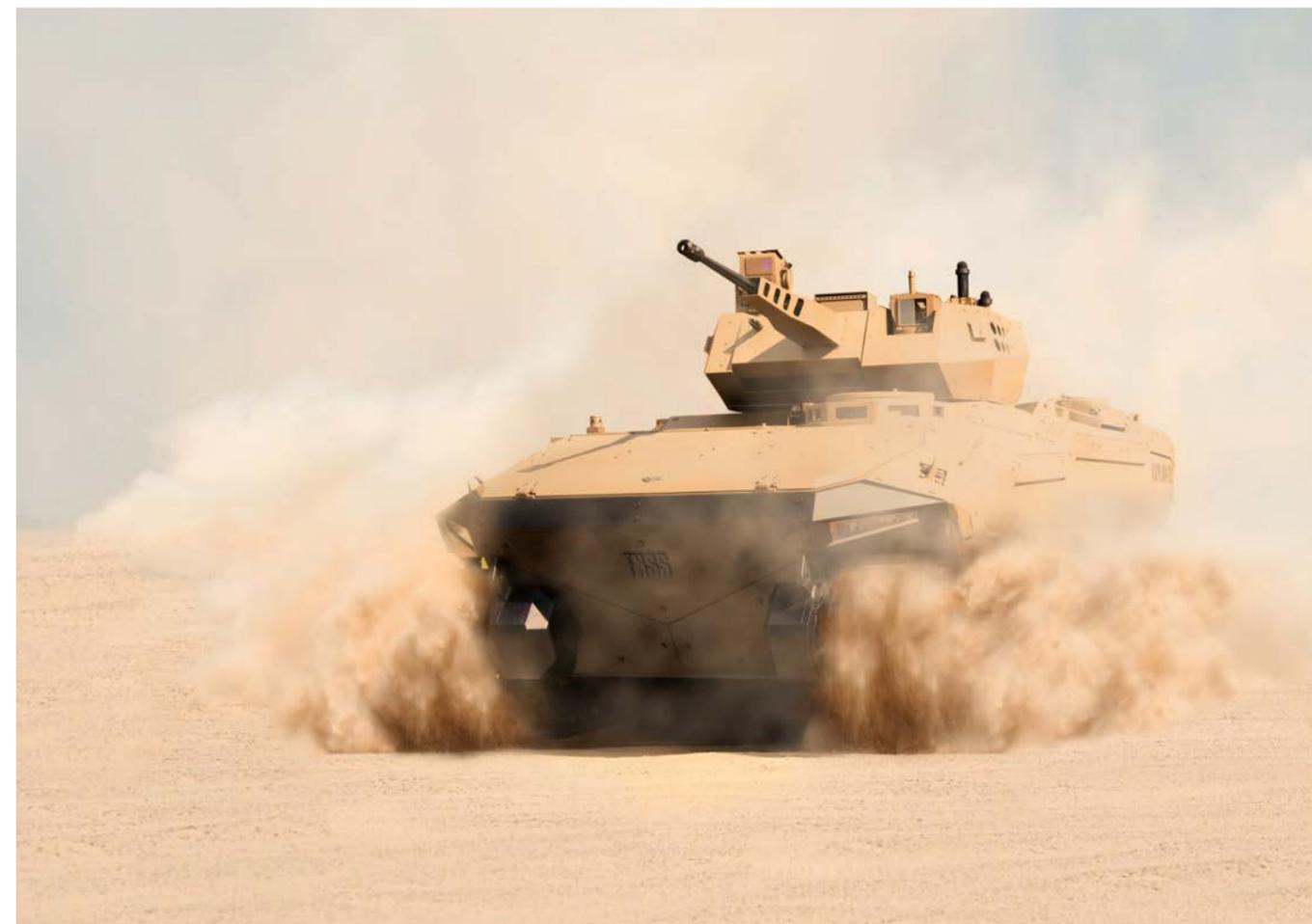
Tiene la capacidad de desplazarse a alta velocidad sobre asfalto o campo traviesa, resistiendo a toda clase de climas y condiciones del terreno. Su avanzado sistema de suspensión se ha diseñado para reducir la vibración del vehículo y aumentar la adhesión a la carretera. Dispone de infraestructura electrónica con arquitectura abierta, con lo que pueden integrarse fácilmente diferentes equipos tácticos según cada necesidad.
