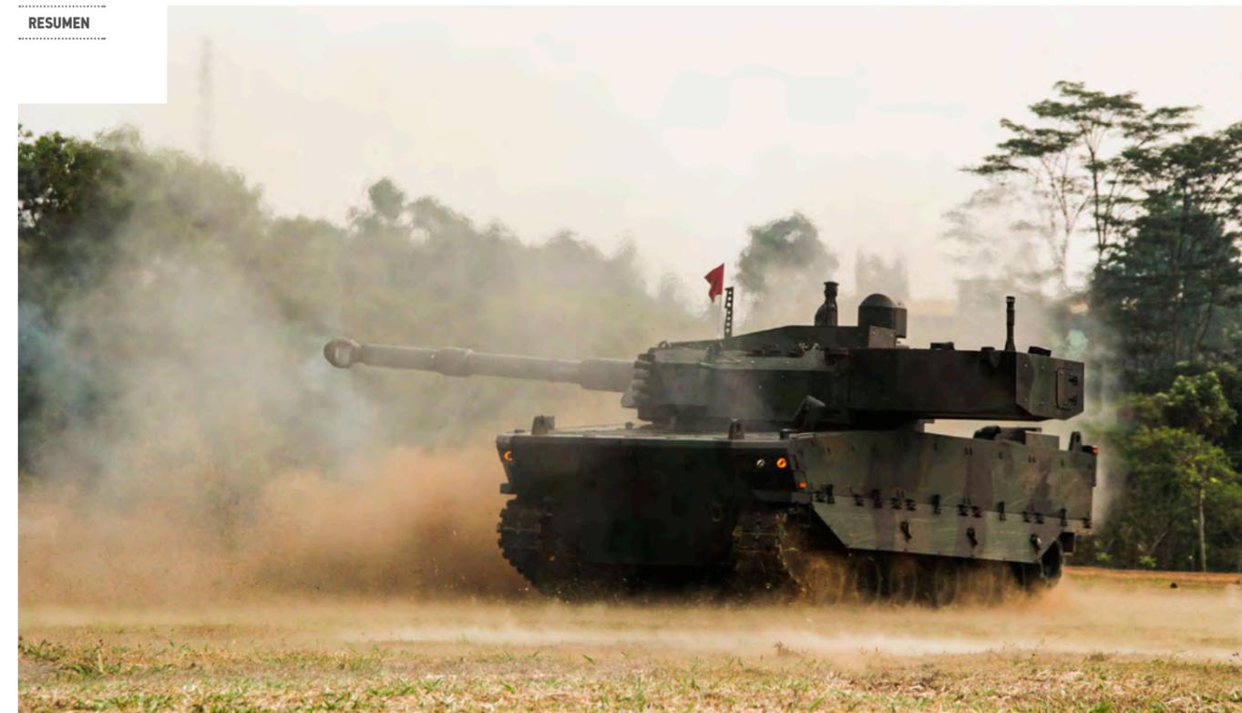
**El KAPLAN MT de última generación es el único y exclusivo tanque mediano actual diseñado con grupo propulsor trasero y que no es una conversión de una variante procedente de un IFV existente.**
