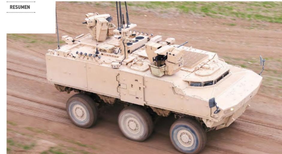
El sistema de armas del vehículo se ha diseñado para combatir múltiples objetivos simultáneamente desde todas las direcciones, incluyendo en terrenos elevados. Dos torres por control remoto están situadas en la sección delantera y trasera del vehículo.
