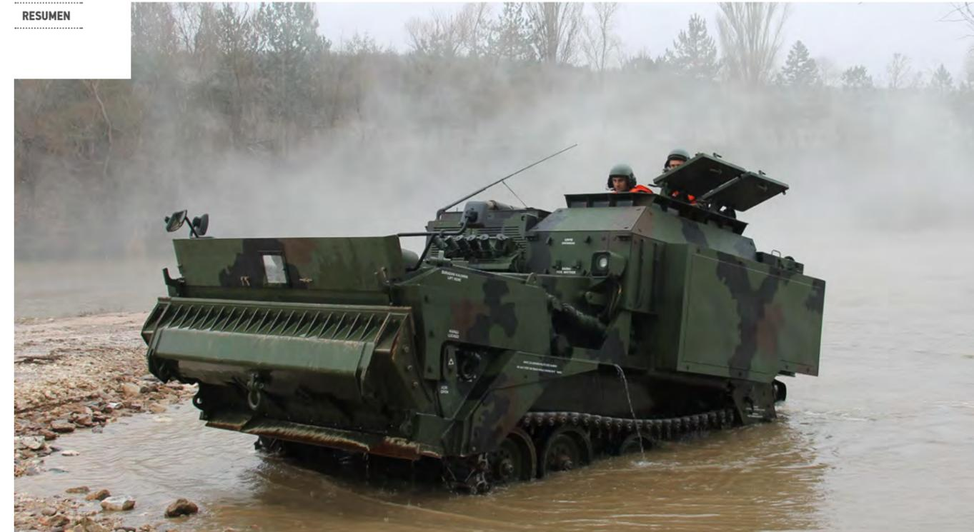
**El AACE es un movedor de tierra blindado de combate anfibia sobre cadenas, diseñado para la preparación de riberas de ríos durante misiones de cruce de ríos. Es capaz de llevar a cabo operaciones de explanado, nivelación, excavación, remolque y arrastre.**
