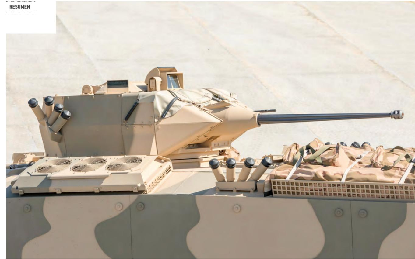
**La SABER es una torre monoplaza de calibre mediano, accionada eléctricamente, que puede integrarse en vehículos blindados sobre ruedas y cadenas. La torre SABER está equipada con las últimas tecnologías en accionamiento de torre, dirección de tiro, protección y letalidad. Sus dimensiones compactas y su reducido peso hacen de la SABER una opción adecuada para diferentes tipos de vehículos blindados.**
