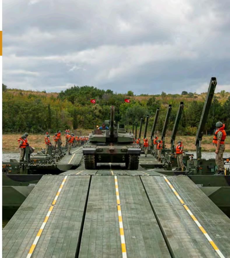
En términos de autosuficiencia, el OTTER puede llevar (4) rampas en un solo sistema, lo que elimina la necesidad de otros vehículos logísticos. El sistema OTTER también dispone de un torno de autorrecuperación, que recupera el vehículo o cualquier otro sistema especialmente en terrenos blandos.
