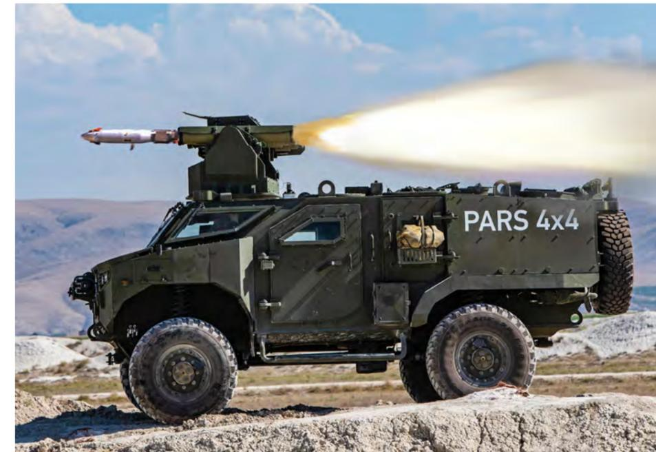
La movilidad del PARS 4x4 se mejora mediante su sistema central de inflado de neumáticos, y también una capacidad antipinchazos gracias a su sistema de disco sólido dentro del neumático. El PARS 4x4 tiene una velocidad máxima de 110 km/h sobre asfalto y una autonomía de 700 km, así como una transmisión automática con un bloqueo de eje para movilidad superior sobre superficies deslizantes y suelo blando.
