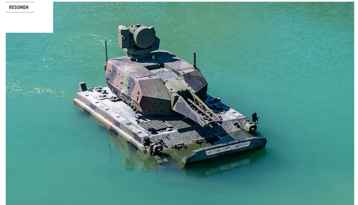
**Gracias a la mayor potencia de su grupo propulsor y a una capacidad de suspensión mejorada, la plataforma ACV AD tiene la posibilidad de llevar cargas útiles más grandes en comparación con otras plataformas antiaéreas pesadas. La plataforma ACV AD también dispone de protección balística y contra minas.**
